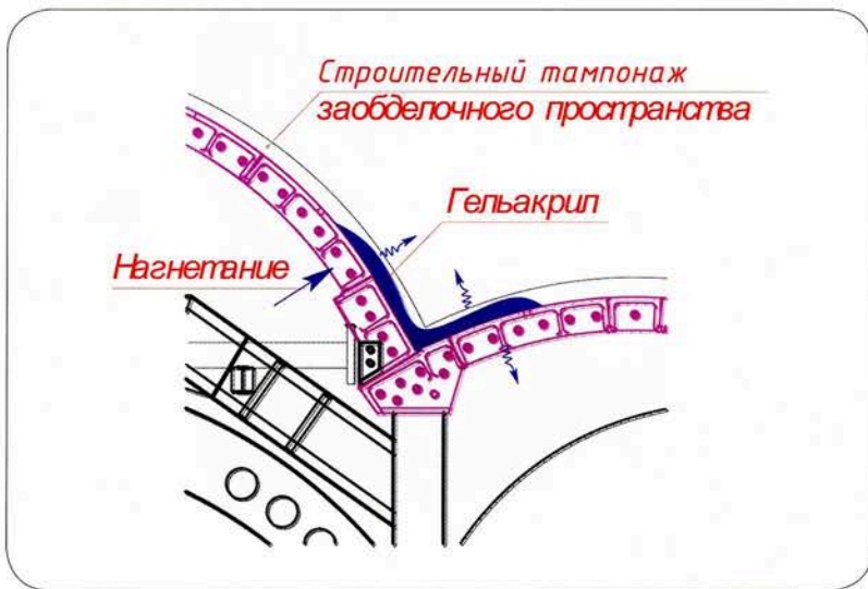
Рис. 3. Схема нагнетания гелякрила
