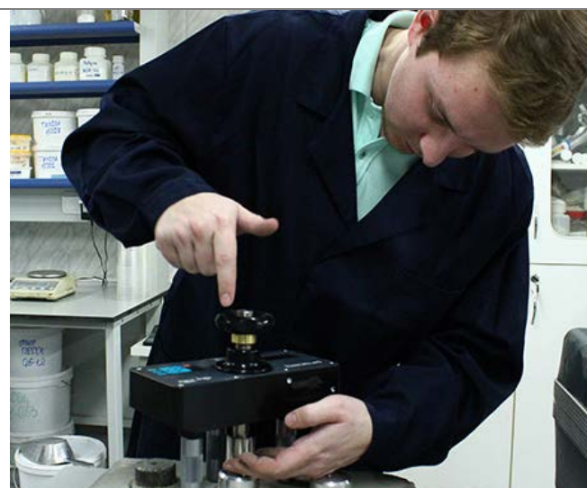
Рис. 6 Определение адгезии ремонтного состава в лаборатории
